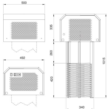
Il refrigeratore C1-W1 è dotato di una serpentina a scambio diretto e, inserito in tini, serbatoi o contenitori controlla automaticamente la temperatura del prodotto grazie al termostato con relativa sonda.
